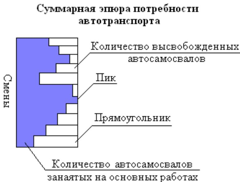
Рисунок 4 – Схема определения количества высвобожденных машино-смен
